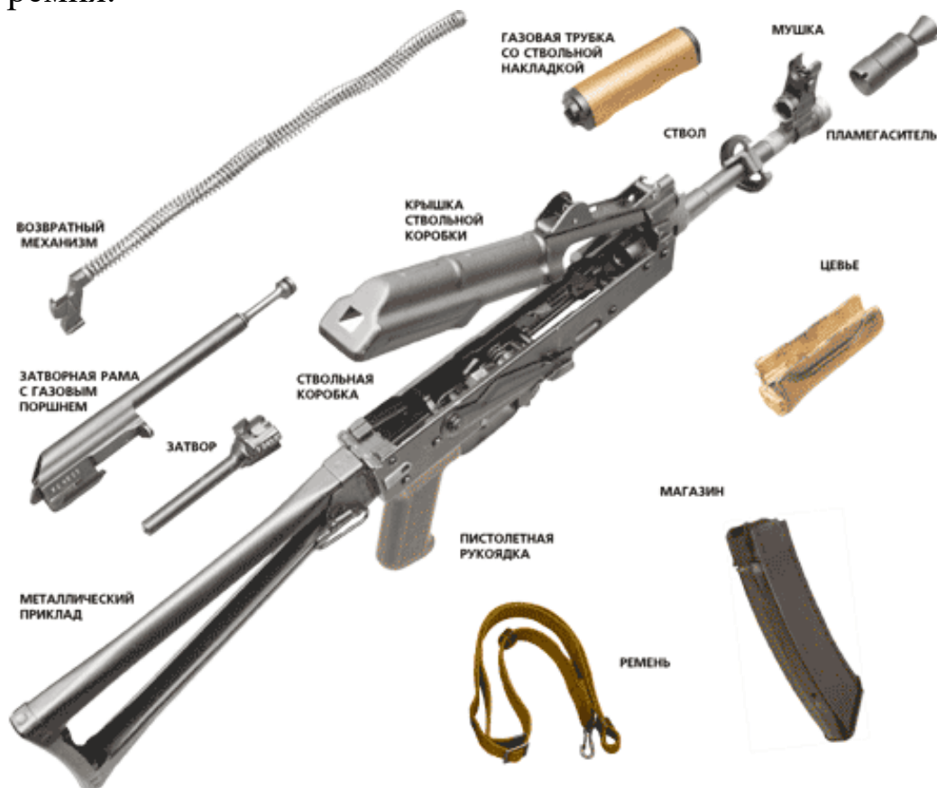
Основные части и механизмы автомата АКС-74У
