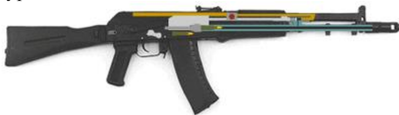
Схема работы сбалансированной автоматики АК-107 / АК-108
